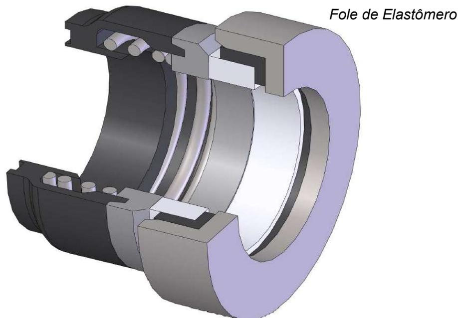
Selos Mecânicos não balanceados de mola única. Produto para uso geral em diversos equipamentos, disponível em milímetros e polegadas. A vedação secundária não deslizante, permite uma facilidade no deslocamento axial e radial. Sua mola protegida impede qualquer tipo de travamento do selo mecânico e o acúmulo de resíduos. Indicado especialmente para as indústrias alimentícias e farmacêuticas.
